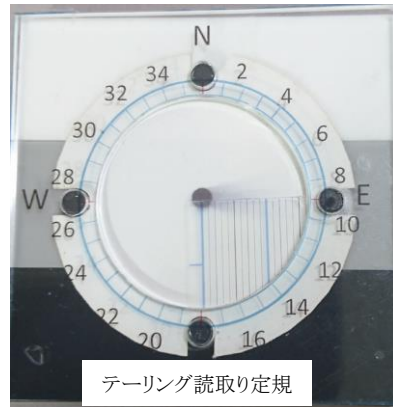
②一定時間静止し引き上げる。ペーパーに発生した尾引き(テーリング)の長さ方位を 専用定規で読み取り流向流速に変換
