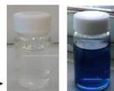
フィルム作製に用いる前駆体溶液でもフォトクロミズムは起こる。→
