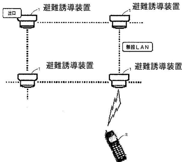
本避難誘導装置は、通信手段、マイクロコンピュータ、センサ、避難情報伝達手段の必要最低限の機能を有していれば良く、中央管理システムが不要なので、中央管理方式に比べて安価にシステムを構築できる。実際の避難経路に沿って避難経路情報が伝達されるので、より正確に避難経路情報を避難者に伝えることができる。
