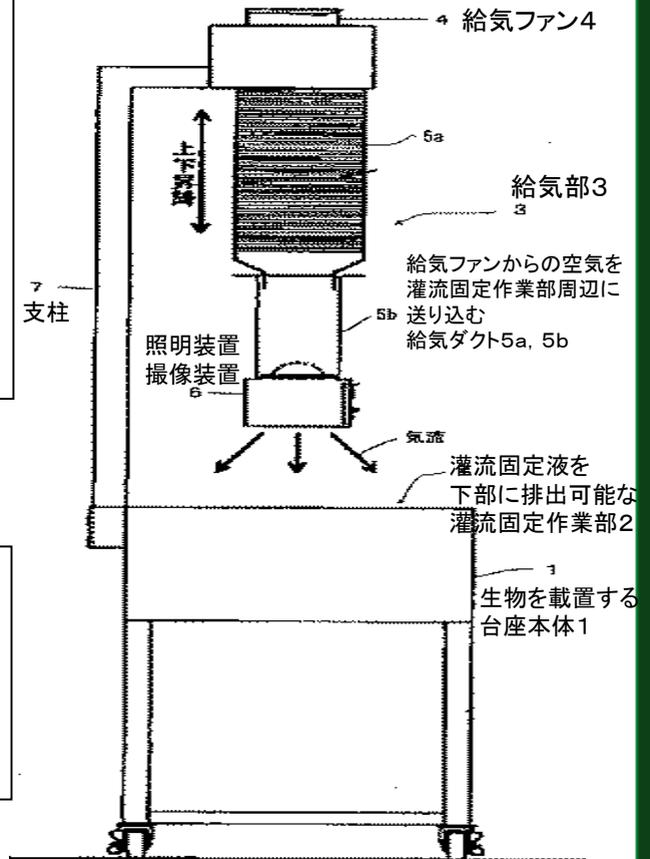
灌流固定処置する生物を載置する給気ダクトはフレキシブルダクトであり、少なくとも給気方向を可変にできる。
