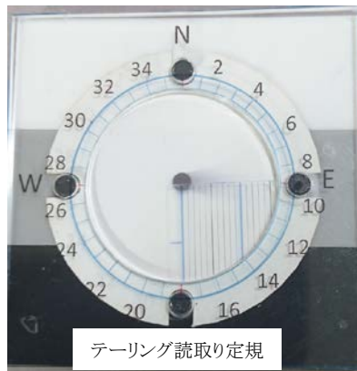
②一定時間静止し引き上げる。ペーパーに発生した尾引き(テーリング)の長さや方位を 専用定規で読み取り流向流速に変換
