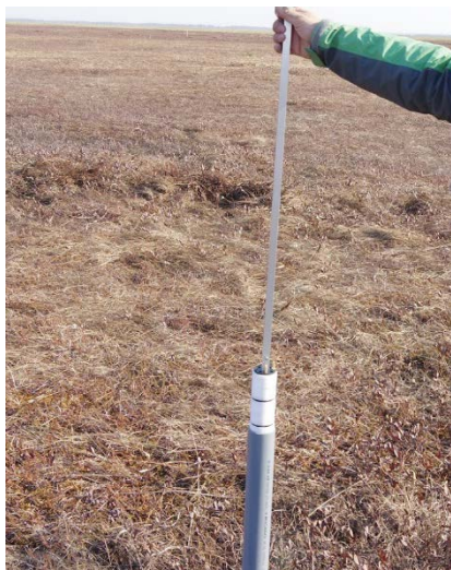
①ペーパー・スポンジをセットし、方位を確かめ 井戸のストレーナ区間に設置
