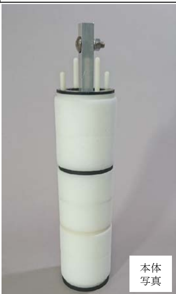
①ペーパー・スポンジをセットし、方位を確かめ 井戸のストレーナ区間に設置
