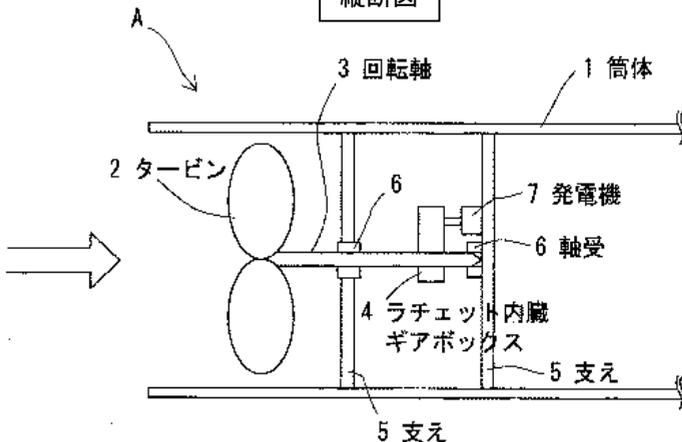
A 振動水柱型波力発電装置用動力変換装置
