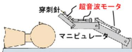
図3. 超音波モータを用いた穿刺システム
